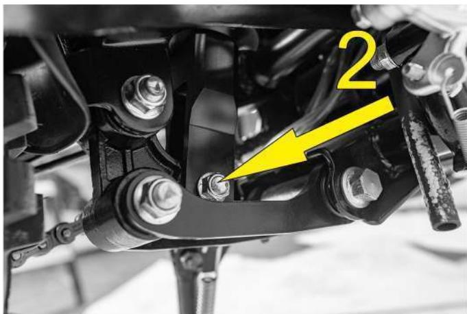
Степень затяжки болтов прогрессии [1] (28 Нм), кроме болта [2] крепления к нижнему уху амортизатора (24 Нм).
