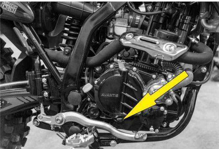
которой имеется щуп с рисками для измерения уровня масла в картере двигателя, так же чуть ниже в картере располагается смотровое окно с рисками, по которому так же можно ориентироваться. Проверка уровня масла осуществляется при опускании щупа в отверстие, без его закручивания!
